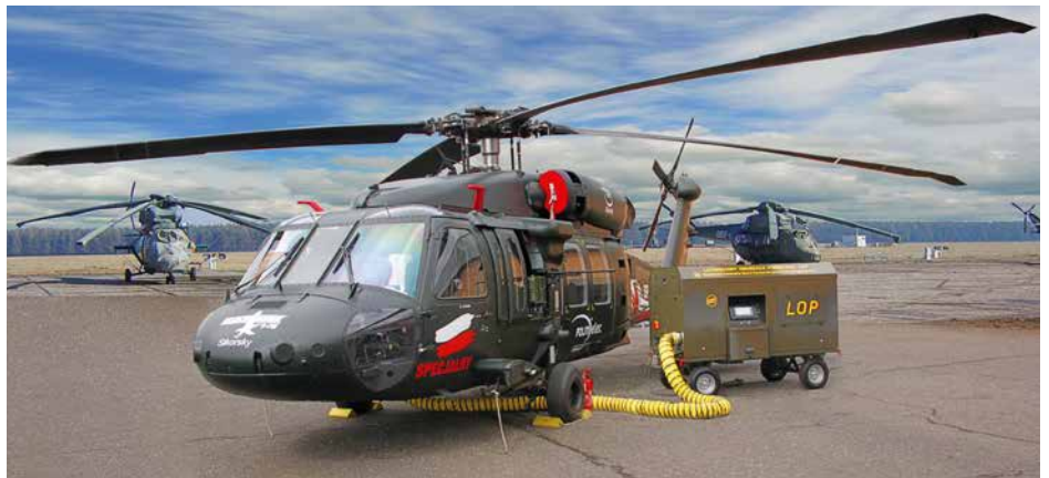
Urządzenia NOSP z WCBKT S.A. są dziś dostosowane zarówno do obsługi statków powietrznych produkcji byłego ZSRS jak i produkowanych przez koncerny zachodnie.
