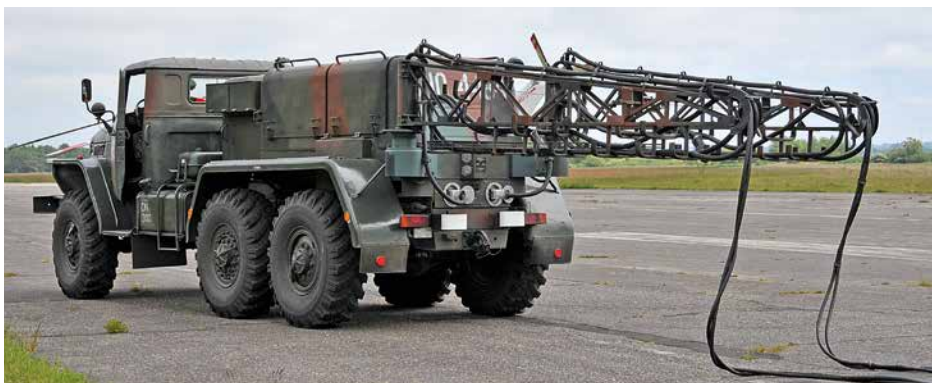
Zamierzeniem WCBKT S.A. jest zastąpienie nowoczesnymi, polskimi urządzeniami do naziemnej obsługi statków powietrznych starego sprzętu produkcji sowieckiej i nielicznych oraz nietypowych urządzeń zachodnich. Na zdjęciu zasilacz elektroenergetyczny APA-5D produkcji ZSRŚ.
