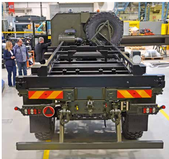
Podwozie Jelcz 442.32. w hali WCBKT S.A. przed zabudową zasilacza elektroenergetycznego.
