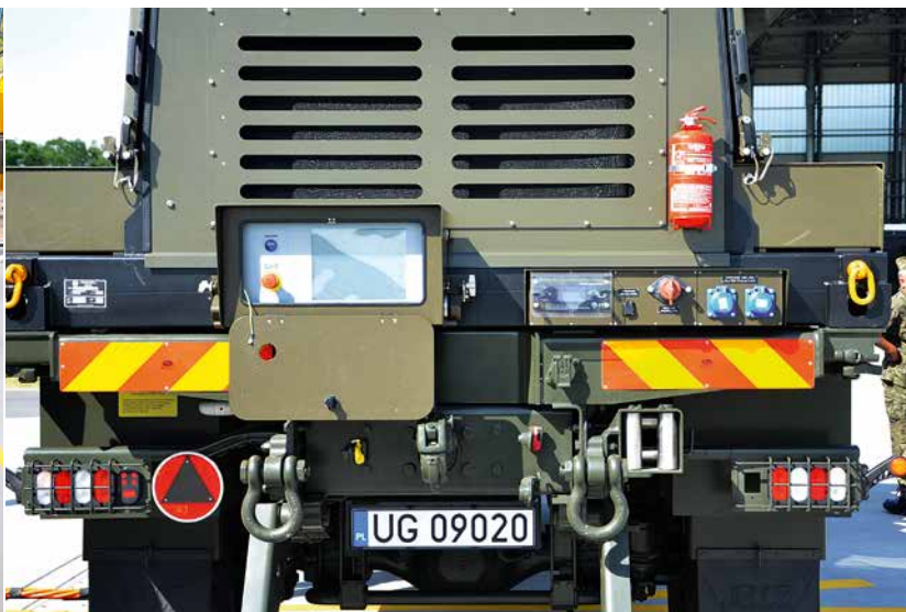
Pulpit sterowania w tylnej części zabudowy najnowszej wersji LUZES-a. Urządzenie może być też obsługiwane z pulpitu przenośnego.
