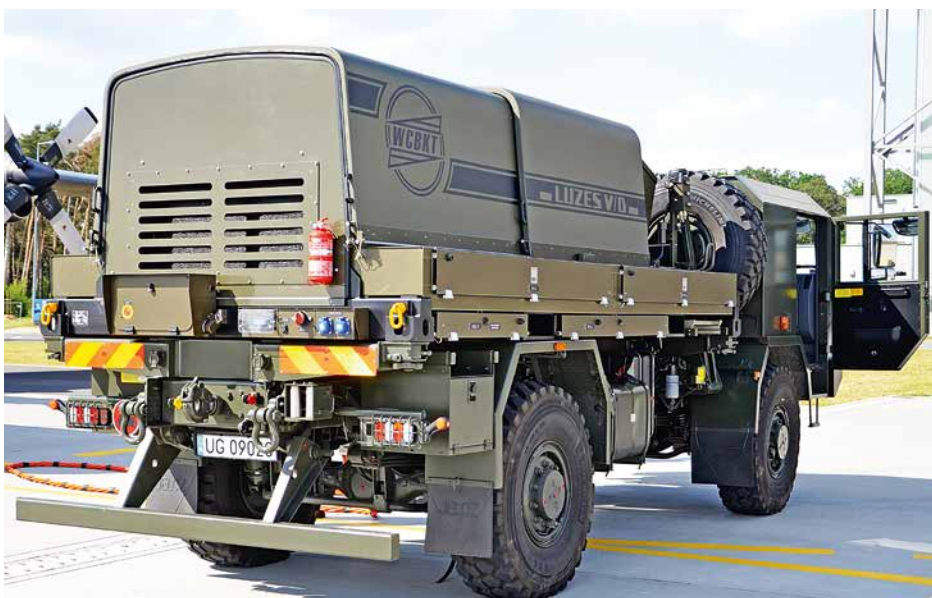
Zamontowanie zasilacza elektroenergetycznego na podwoziu wysokiej mobilności zwiększa możliwości jego wykorzystania, nawet do obsługi statków powietrznych, które lądowały w przygodnym terenie.
