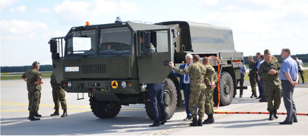
Wybrany jako nośnik Jelcz 442.32 jest samochodem ciężarowym średniej ładowności wysokiej mobilności. Zbudowany w układzie dwuosiowym 4x4, zaprojektowany przez Jelcz Sp. z o.o. z przeznaczeniem dla SZ RP.
