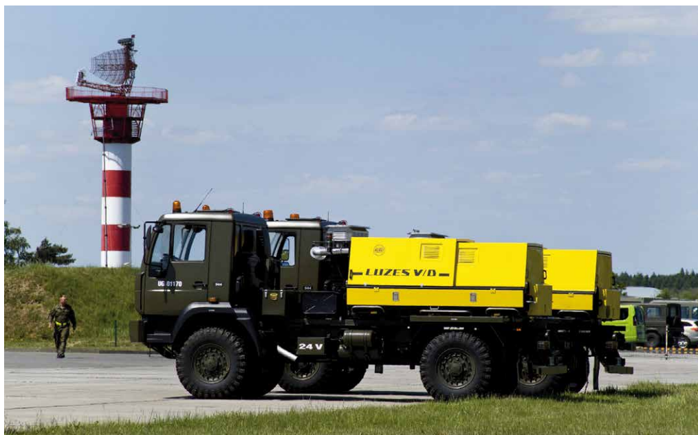
Zasilacze elektroenergetyczne LUZES V/D to popularny widok w bazach lotniczych Sił Zbrojnych RP. Są zdolne do zasilania w energię każdego wojskowego załogowego statku powietrznego.
