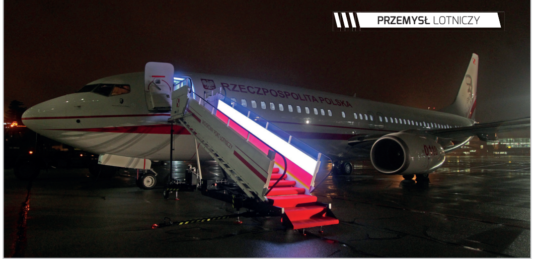
➤ Specjalna wersja schodów pasażerskich LSP 3S do obsługi rządowego samolotu Boeing 737-800.
