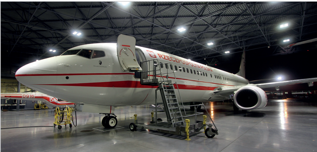
➤ Podest serwisowy – inne urządzenie pochodzące z WCBKT S.A., umożliwiające naziemną obsługę m.in. samolotu Boeing 737.
