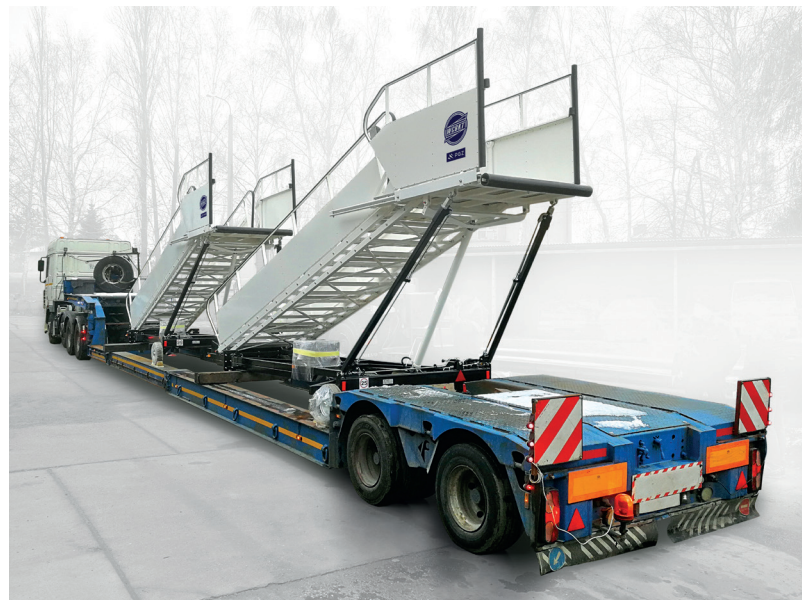
➤ W bieżącym roku WCBKT S.A. dąży do podpisania kontraktu na wyposażenie terminala cargo i wyposażenie terminala pasażerskiego na jednym z największych cywilnych lotnisk w kraju. Na zdjęciu: schody pasażerskie LSP 3S na lawecie.
