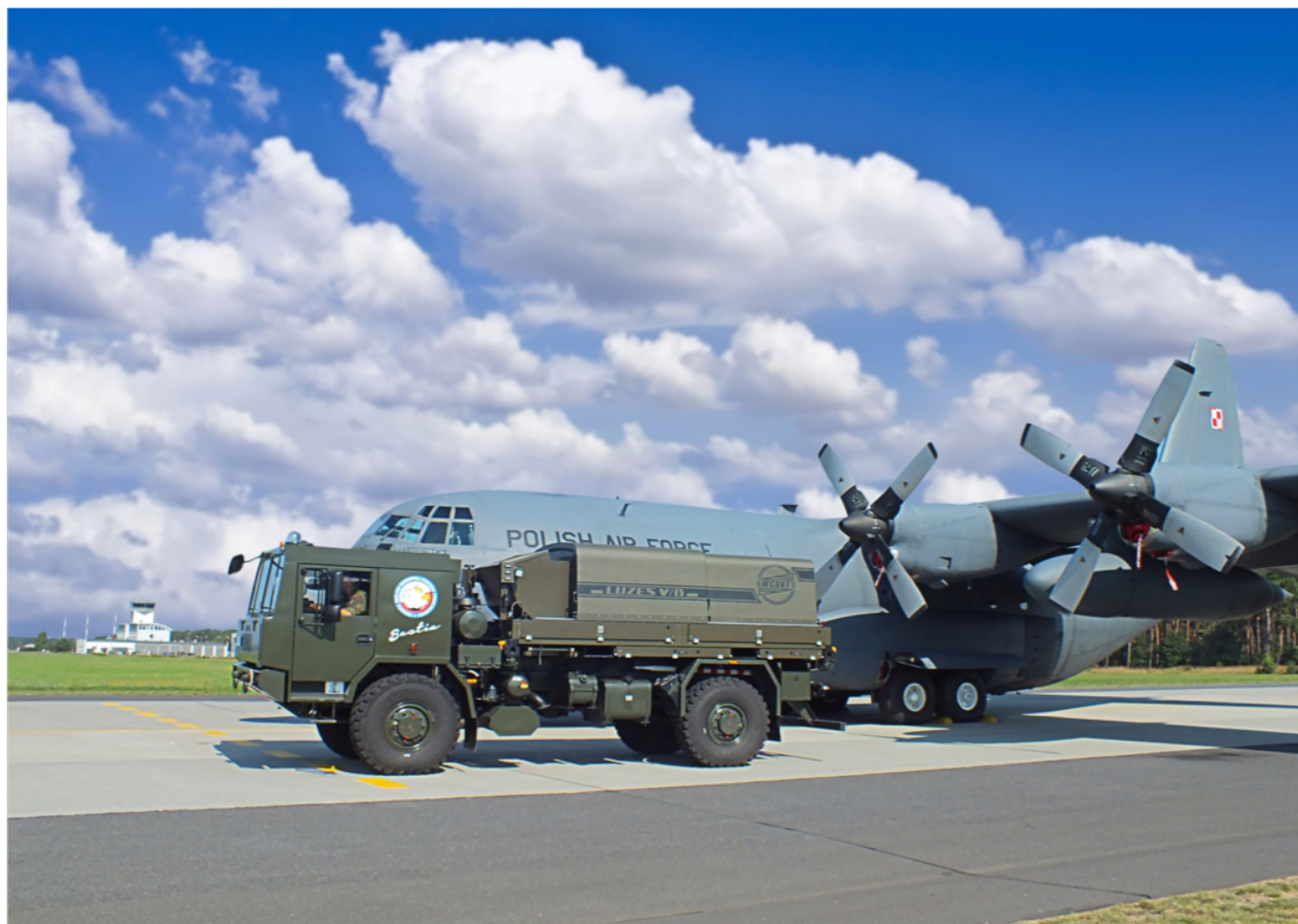
Zasilacz elektroenergetyczny Luzes V/D seria V na Jelczu podczas obsługi samolotu C-130 HERCULES. Fot. WCBKT S.A.
