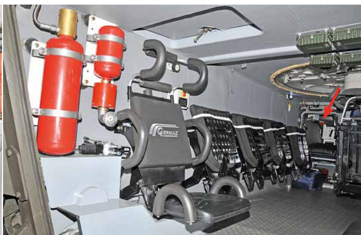
Butle i dysze rozpylające jednej ze starszych wersji systemu Stopfire zamontowane w 2011 r. demonstratorze technologii wielozadaniowej platformy gaśniczej Anders. W głębi, przy stanowisku kierowcy, widoczna głowica optyczna GO-1 systemu.
