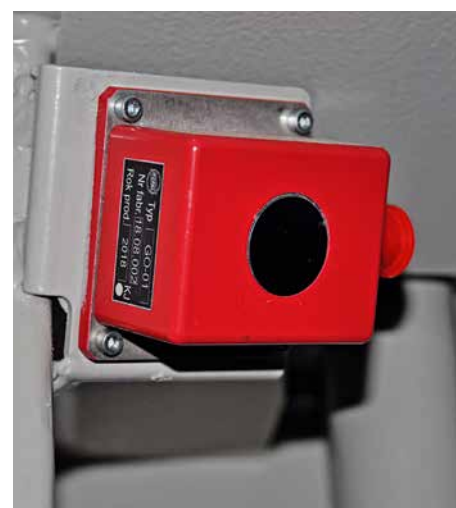
Jedna z głowic optycznych GO-1 zamontowanych w przedziale desantowym modelu funkcjonalnego NPBWP Borsuk.
