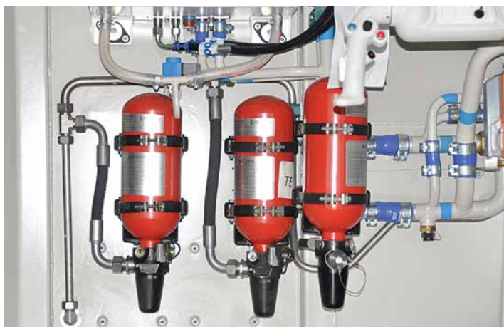
Układ gaśniczy przedziału załogi UGPZ systemu Stopfire w aktualnej wersji zamontowane w przedziale desantowym modelu funkcjonalnego NPBWP Borsuk.
