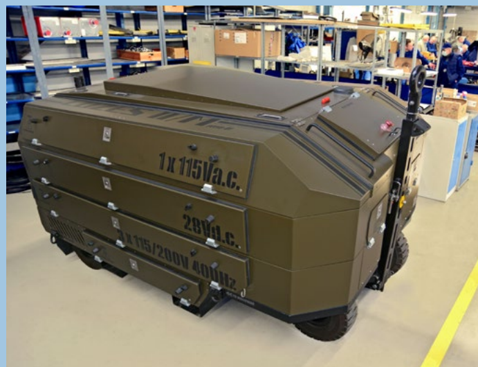
Lotniskowe Urządzenie Zasilania Elektroenergetycznego Staków Powietrznych LUZES II/M najnowszej VI generacji zgłoszone do konkursu DEFENDER. Fot. WCBKT S.A.
